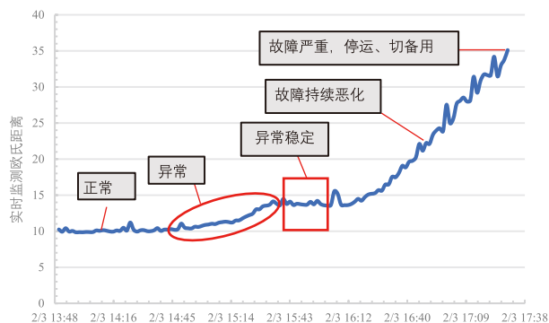
某9E燃机电厂高压给水泵驱动端轴承损坏时DMSET智能预警监测曲线
