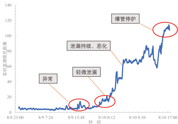
某660MW超超临界燃煤电厂末级过热器爆管前DMSET智能预警监测曲线
